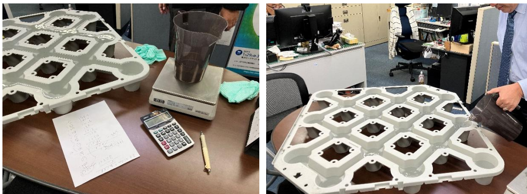
写真 2-17 貯水量の計測状況
