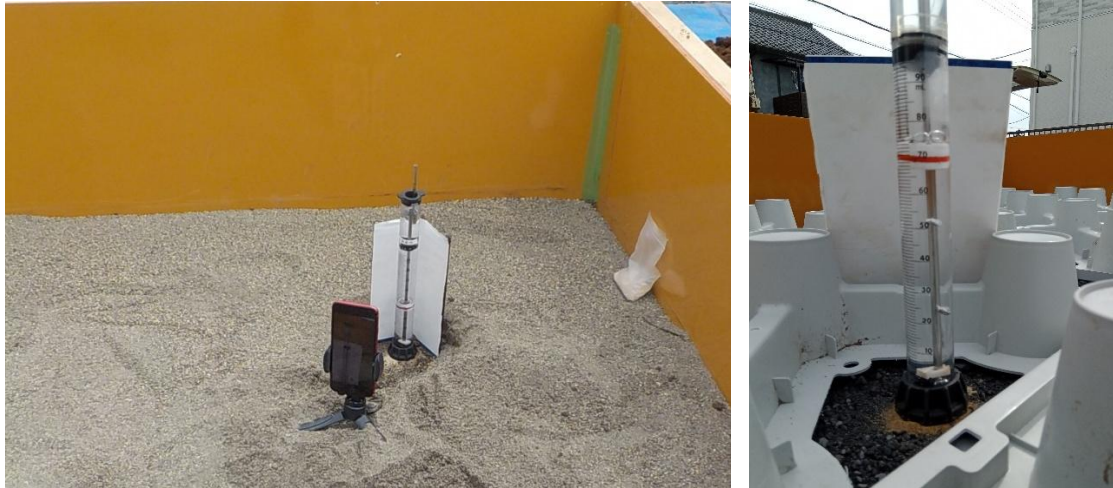
写真 2-12 インフィルトロメータによる計測状況(左:路床、右:路盤)
