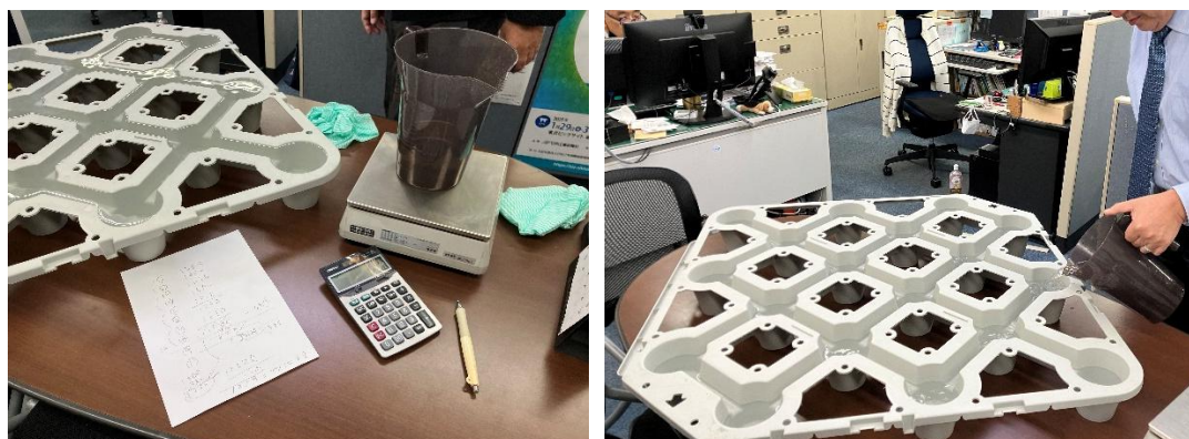
写真 2-17 貯水量の計測状況
