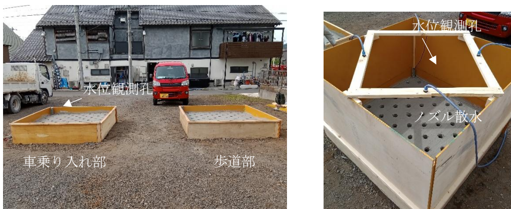
写真 2-10 散水試験施設
