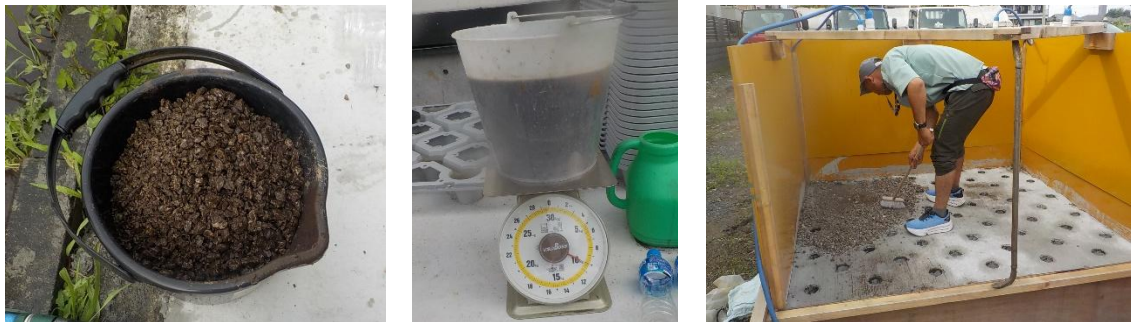
写真 2-16 回収した砂利、洗浄後の懸濁溶液の重量測定、洗浄した砂利の再充填
