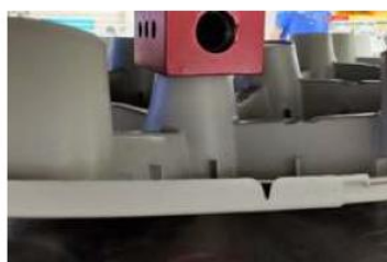
※合流部が開くように変形。(合流部が多いほど弱い)
