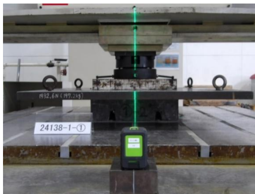
写真 2-9 圧縮試験の状況
